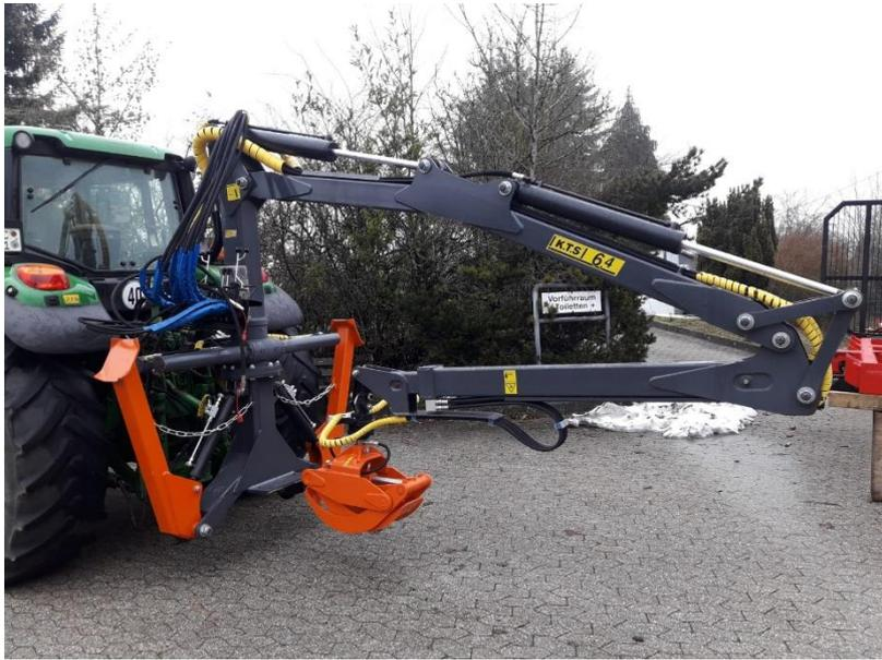
Kran KTS 6.4 mit einer Reichweite von 6,4m, (oben liegender Zylinder)
