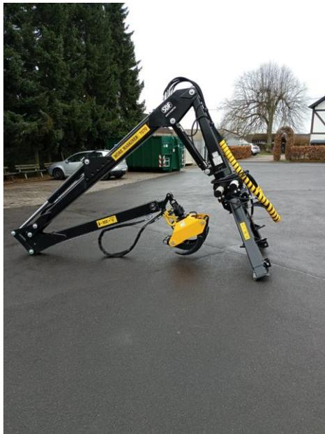
**Kran Möre Maskiner 7070 mit einer Reichweite von 7 m,**
