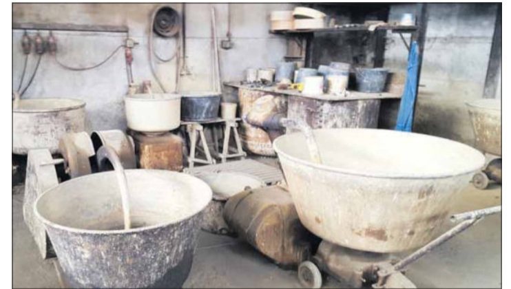
Mit ehemaligen Teigmischmaschinen der Dauner Brotfabrik wird das Lehmgemisch vorbereitet
