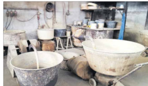
Mit ehemaligen Teigmaschinen der Dauner Brotfabrik wird das Lehmgemisch vorbereitet
